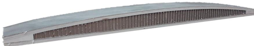
Von TU Graz und BOKU entwickelte und patentierte Seitenaufprallträger eines konventionellen Pkws aus Holzwerkstoffen und Naturfaserverstärkung. Das Crashelement ist zu mehr als 90 Prozent aus bio-basierten Materialien hergestellt. Nur Klebstoffe und Beschichtung sind nicht biologischen Ursprungs. Eine Umweltbewertung des Bauteils zeigt eine ca. 30-prozentige Verbesserung der CO<sub>2</sub>-Bilanz.
